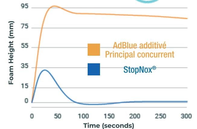
**Moins de mousse = Versage facilité, évite de mettre en défaut les capteurs**
